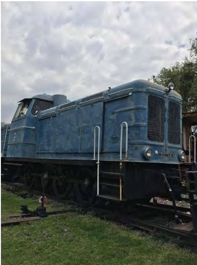
Locomotora de tracción diésel-hidráulica VW-118
